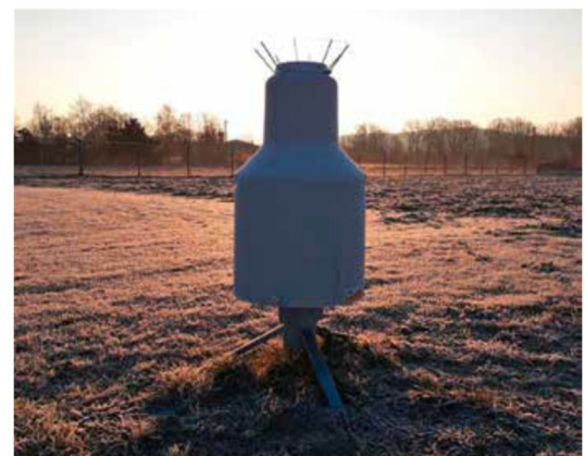
Abb. 5: Niederschlagsmesser Pluvio² L (Firma OTT) auf dem Testfeld Brandis
