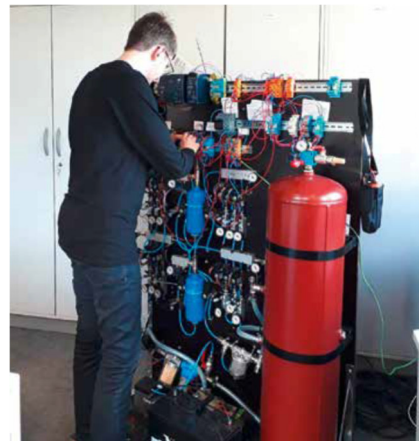
Abb. 4: Montage des Prototyps für die automatische Probenahme an BDF-II-Flächen
