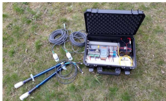
Abb. 11: Messkoffer zur Kalibrierung Tensiometer und TDR-Sonden
