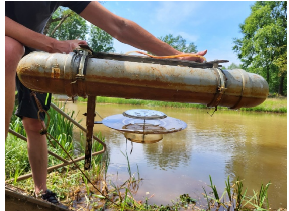
Abb. 23: Befestigung einer Tellerfalle an einem Schwimmkörper.
