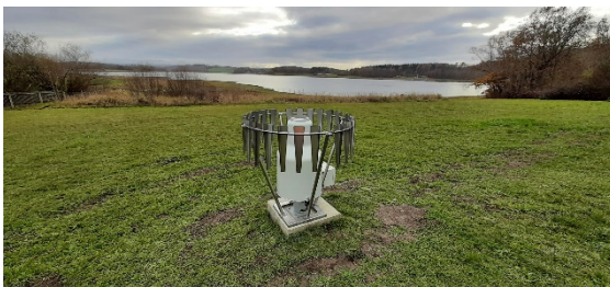
Abb. 16: Umgesetztes Ombrometer Pöhl mit neuem Messgerät
