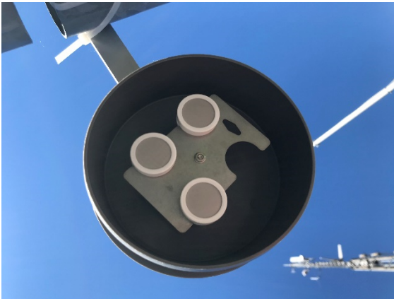
Abb. 6: Passivsammler zur Bestimmung von Ammoniak.
