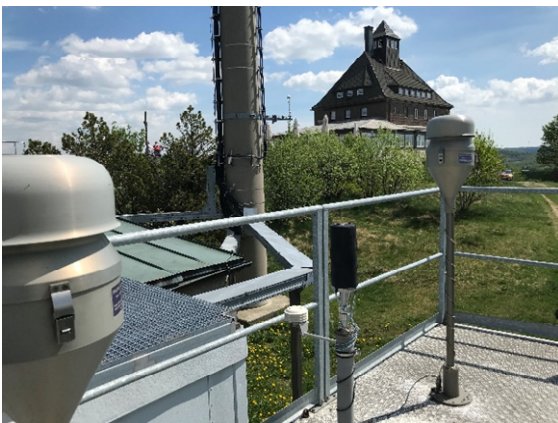
Abb. 7: Dach der Luftgütemessstation am Schwartenberg mit dem zusätzlichen High-Volume-Sampler für die Erfassung der Feinstaubfraktion PM2,5.
