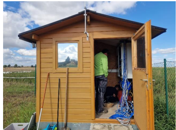
Abb. 13: Aufbau der automatischen Bodenwasserprobenahme an der BDF II Station Schmorren
