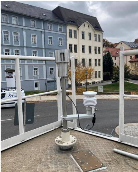
Abb. 8: Sondenkopf für ein Messgerät zur kontinuierlichen, zeitaufgelösten Staubmessung auf der Basis von Streulichtdetektion, am Standort Freiberg.
