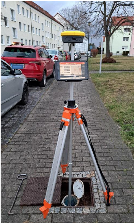
Abb. 12: Koordinatenüberprüfung an einer Grundwassermessstelle mit dem Geomax Zenith 60.
