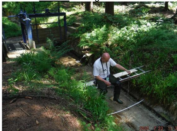
Abbildung (Abb.) 1: Durchflussmessung am Hanggraben als Zulauf zur Talsperre Cranzahl, Beispiel für die Messung von Geringstdurchflüssen.
