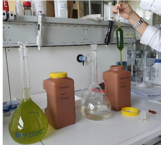
Abb. 11: Herstellung der Dosierlösung für LÜRIV "Chlorophyll in OW".
