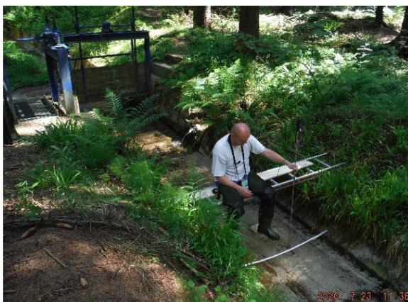
Abb. 1: Durchflussmessung am Hanggraben als Zulauf zur Talsperre Crazahl, Beispiel für die Messung von Geringstdurchflüssen.
